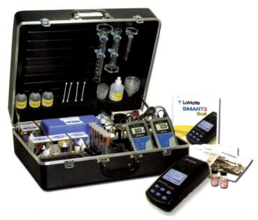
El laboratorio electrónico Lamotte SCL-12 está diseñado para que el agricultor, o los especialistas en fertilizantes o en análisis dispongan de un método de análisis económico e inmediato que se realiza en el campo y de manera precisa. El modelo SCL-12 es un auténtico laboratorio electrónico de análisis que mide de forma precisa 15 factores del suelo incluyendo los macronutrientes y los micronutrientes.
