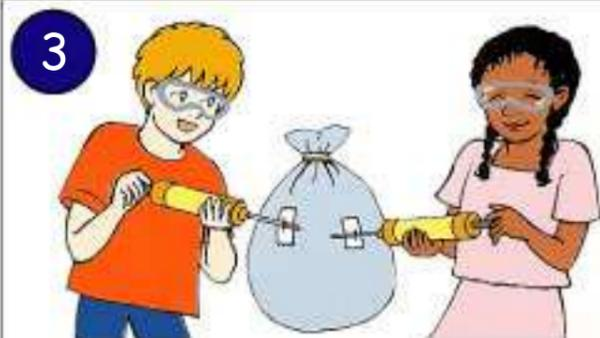
**3** Introduzca un tubo detector 2EL para medir dióxido de carbono en una bomba tomamuestras GV-50P y un tubo detector 31E para medir oxígeno en la otra bomba. Quita los trozos de cinta adhesiva que tapan los agujeros e introduce los tubos detectores por los agujeros. Mide la concentración de dióxido de carbono con el tubo detector 2EL y la concentración de oxígeno con el tubo detector 31E y anota los resultados.
