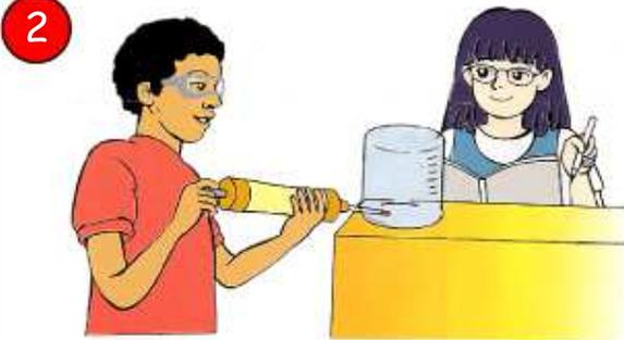
**2** Introduce un tubo detector 2EL para medir dióxido de carbono en la bomba tomamuestras e introduce el tubo por la abertura del vaso de precipitados. Mide la concentración de dióxido de carbono y anota el resultado.
