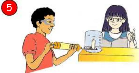
**5** Inserta el tubo detector de dióxido de carbono 2EH en la bomba tomamuestras e introduce el tubo por la abertura del vaso de precipitados. Mide la concentración de dióxido de carbono y anota el resultado.
